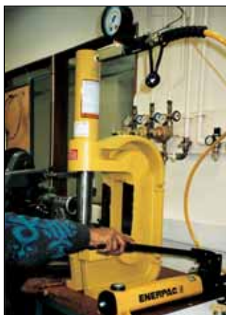
◀ A-310 C-presse brukes for holde sammenpressing av pulver med 10 tonns kraft.
