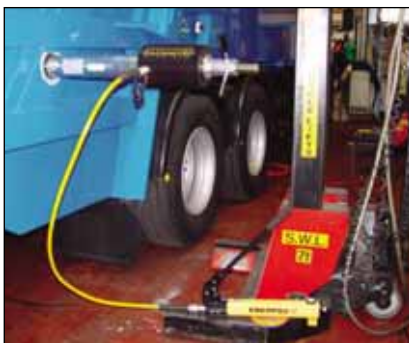
◀ En RACH-306 trykksatt med P-392 håndpumpe brukes til å trekke ut korroderte bolter på renovasjonsbiler.
