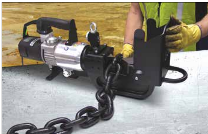
◀ Enkel kutting av kjettingledd med Enerpac kjettingkuttere.
