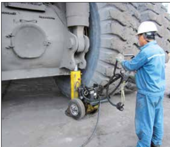
◀ Enerpac POW'R-RISER® er brukt i gruvedrift til å løfte tungt utstyr.
