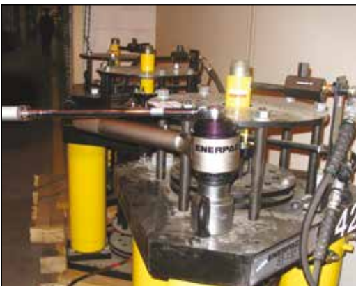
◀ Enerpac momentforsterker med reaksjonsstang E393 benyttes til å tilføre bolter opptil 4300 Nm manuelt dreiemoment.
