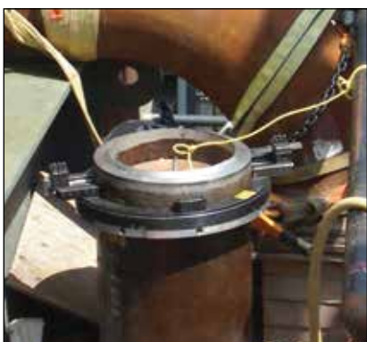
◀ NB-modell gripekutteverktøy med smalt hovedstykke.
